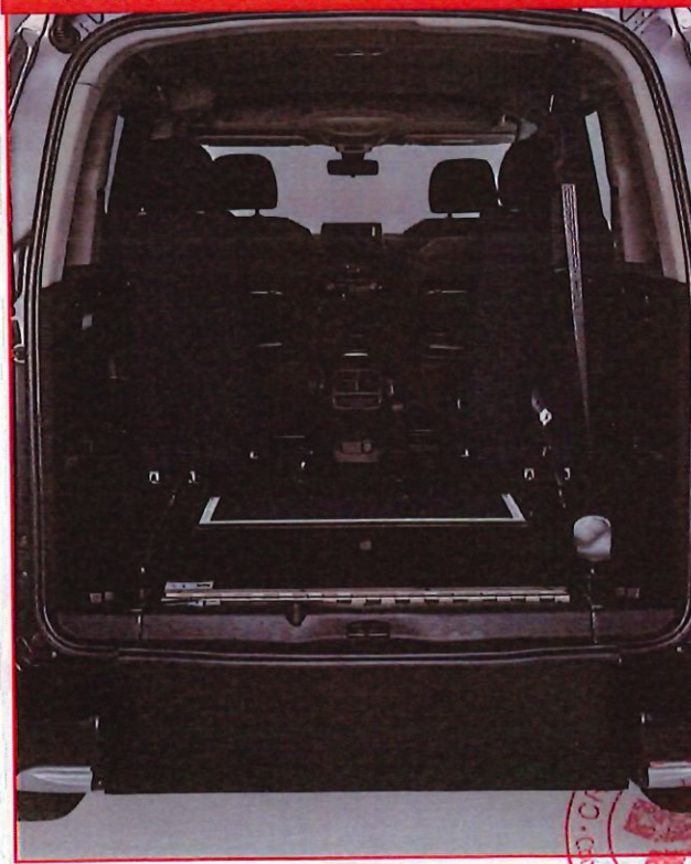
RAMPA RIPOSTA IN ASSENZA DEL DISABILE
