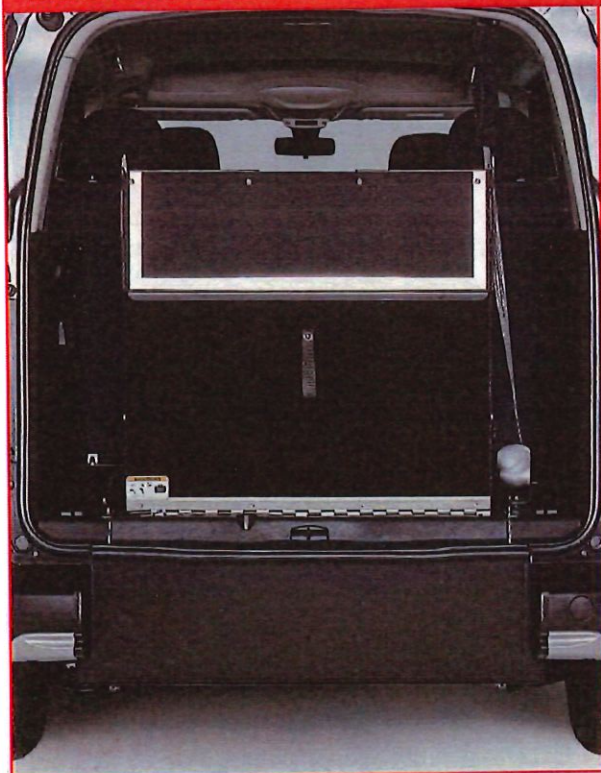
RAMPA CHIUSA CON CARROZZINA A BORDO
